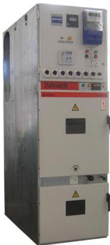
Камеры сборные одностороннего обслуживания серии КСО/РТН (далее – КСО) предназначены для приема и распределения электрической энергии переменного трехфазного тока промышленной частоты 50 Гц на номинальное напряжение 6; 10 кВ и токи 630, 1000, 1250А для сетей с изолированной или компенсированной нейтралью для комплектования закрытых распределительных устройств.
