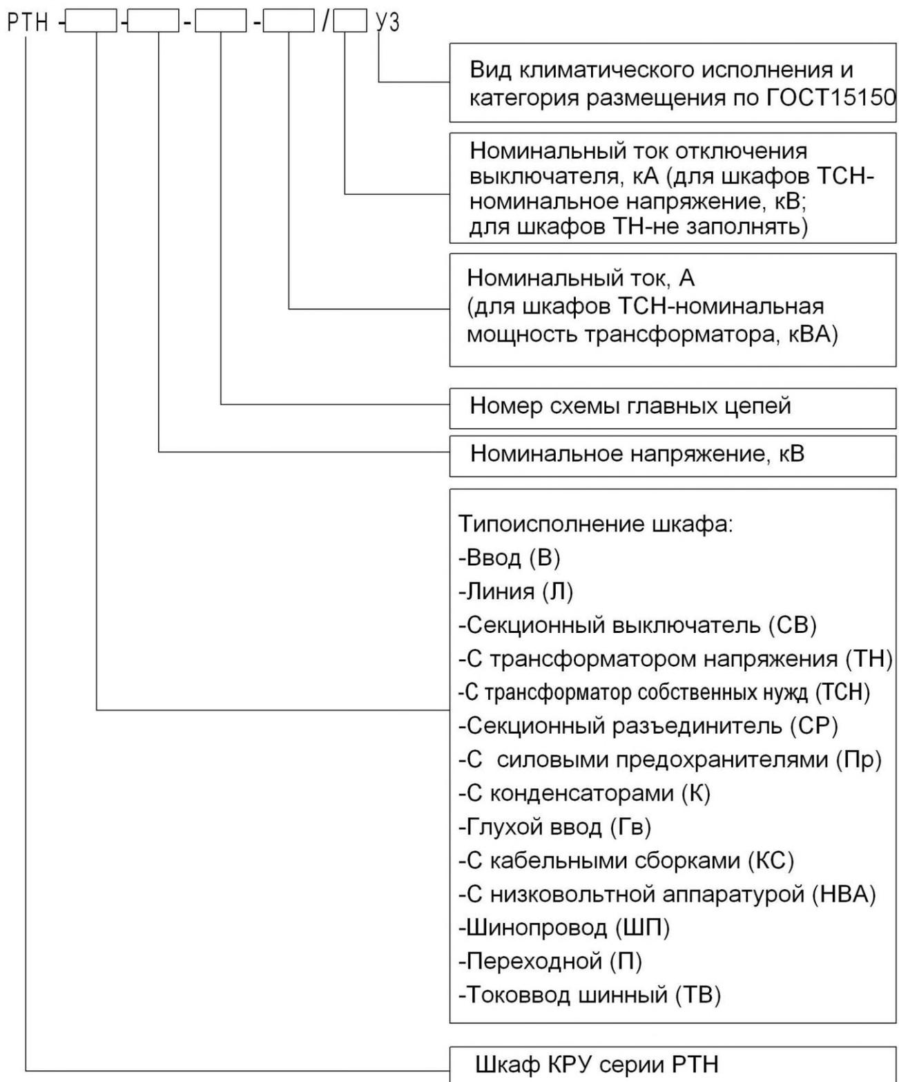
Пример записи при заказе шкафа КРУ серии РТН (линия) на номинальное напряжение 10 кВ, по сетке схем главных цепей 002, на номинальный ток 630 А, номинальный ток отключения выключателя 20 кА, вид климатического исполнения УЗ:
